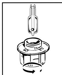
Vous pouvez remplacer vous-même la lampe lorsqu'elle ne fonctionne plus. Dévissez le hublot puis sortez la lampe (utilisez un gant de caoutchouc qui facilitera le démontage). Insérez la nouvelle lampe et replacez le hublot. Ce produit contient une source lumineuse de classe d'efficacité énergétique G.
